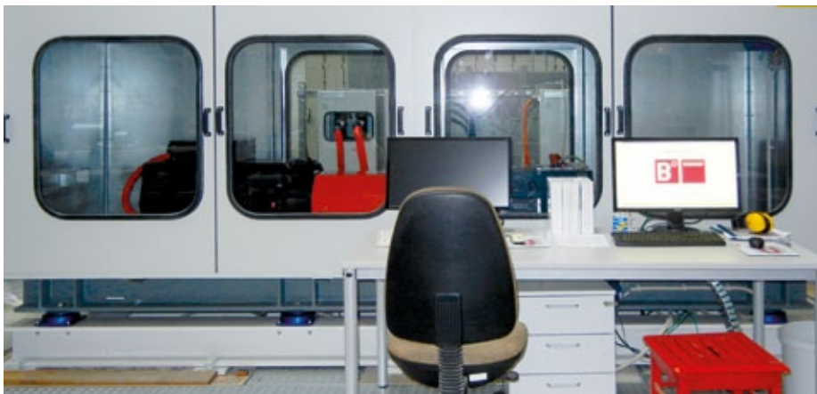
Prüfstand für elektrische Maschinen und Antriebe: Schwerpunkt Energieeffizienz und Elektromobilität
