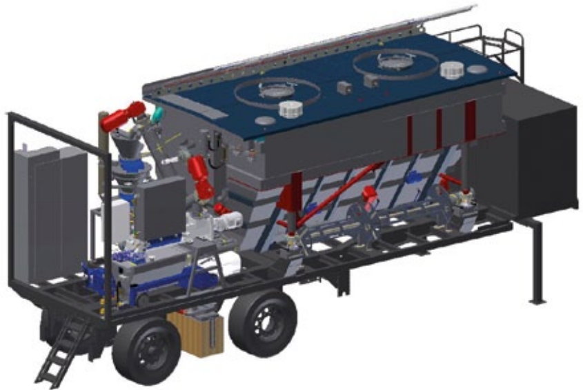
Mobiler PumpTruck m-tec PT mit Berghof Steuerungstechnik
